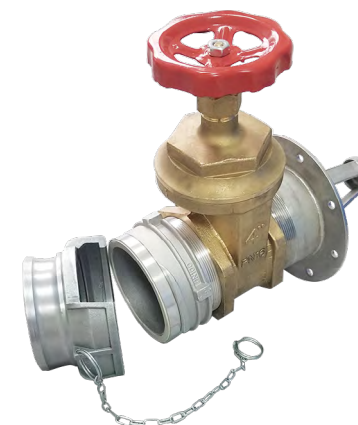
Prise directe sur le flanc - Non hors gel Vanne guillotine laiton DN100 Raccord pompier sans tenons
